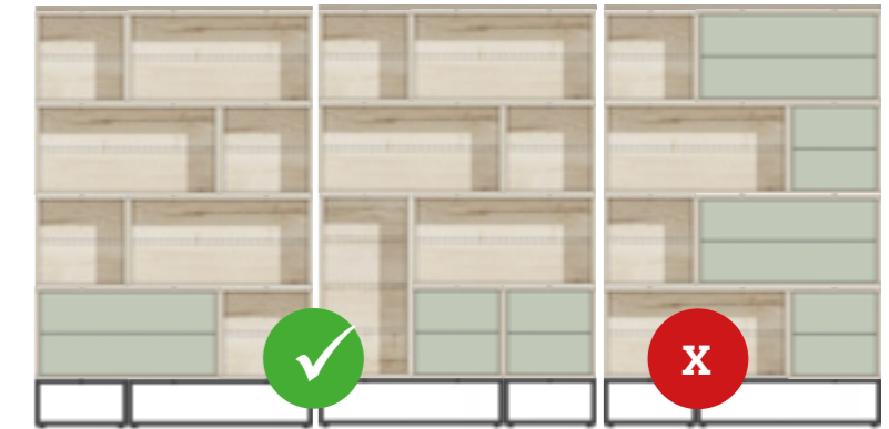
Schubkastenauszüge oder Schubkästen in der Vertikalachse - nicht mehr als 1 Element (800 mm) oder 2 Elemente (400 mm) pro 800 mm Vertikalachse
