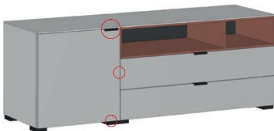
Bei den Türen kann der Griff nach Kundenwunsch oben, unten oder seitlich montiert werden. Die Montagepunkte sind werkseitig markiert, die Montage erfolgt durch den Monteur beim Kunden.
